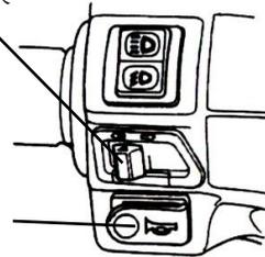
(5). 将主开关钥匙转到“关闭”位置，并按下喇叭按钮，如果喇叭不响，则保险丝可能已熔断。
