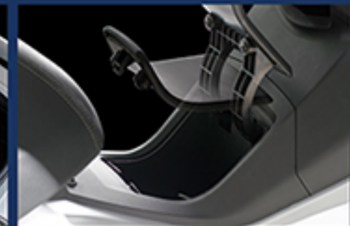
中控弹开式加油盖
