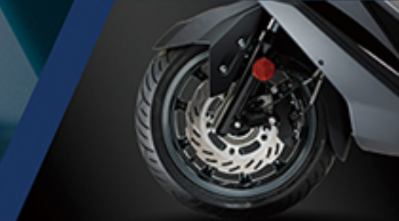
BOSCH ABS x 260mm碟盘 x 对向四活射卡钳
