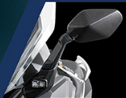
可折式后视镜/高亮度LED方向灯
